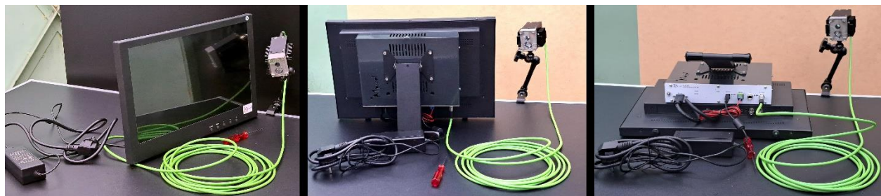
Przykład montażu kontrolera MU156 na śrubach VESA z tyłu monitora
